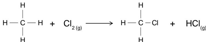
En moléculas de alcanos más grandes, es posible que el halógeno ataque diferentes átomos de carbono de la molécula, y produzca una mezcla de compuestos orgánicos monohalogenados. Si la reacción se deja seguir adelante, pueden formarse compuestos orgánicos di-, tri-, o polihalogenados.
