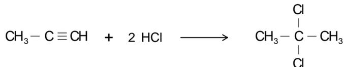
La adición de halogenuros de hidrógeno a los alquenos se usa a menudo como ruta sintética para preparar halogenuros de alquilo. Generalmente, se burbujea  $\text{HX}$  gasoso a través de una solución de alqueno.
